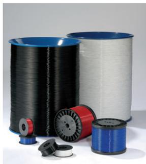
Der NC-Draht, der auch Spiraldraht genannt wird, ist ein sehr flexibler, nylon-beschichteter Eisendraht. Die Abmessungen liegen zwischen 0,70 mm und 2,00 mm. Auch bezüglich der Spulen gibt es Auswahlmöglichkeiten.\* Der Spiraldraht ist in diversen Farben erhältlich und wird überwiegend in der Produktion für Bürobbedarf eingesetzt.
